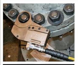
La gamme de clés **VERSA** est une gamme de clés dynamométriques hydrauliques conçues par **HYTORC USA**. Cette série à été conçue pour les opérations de maintenances occasionnelles. Le système d'entrainement de cette série VERSA est différent des autres gammes de clés HYTORC. Ces clés n'intègrent pas le système d'entrainement anti-retour. Toutefois ces clés conviennent parfaitement aux clients souhaitant investir dans un équipement d'entrée de gamme.
