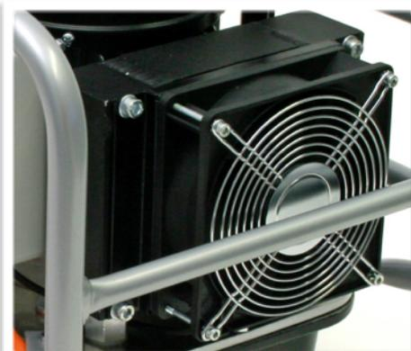
Ce tout nouveau groupe moto pompe fabriqué par HYTORC Allemagne à été conçu pour les utilisations intensives en serrage SIMULTORC avec plusieurs clés dynamométriques hydrauliques de même tailles; Ce groupe moto pompe peut piloter simultanément jusqu'à 4 clés HYTORC de tailles conséquentes en mode automatique.
