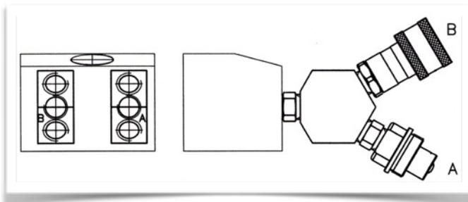
Adaptateur double sortie pour pilotage de 2 clés hydrauliques de même taille en serrage ou desserrage simultané.
