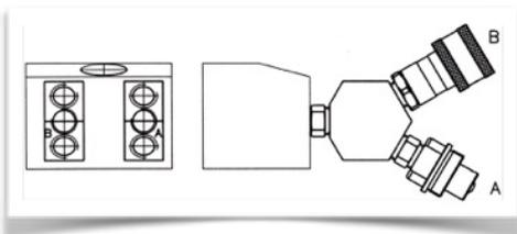
\* Adaptateur double sortie pour pilotage de 2 clés hydrauliques de même taille en serrage ou desserrage simultané. Référence: 3 32142 00
