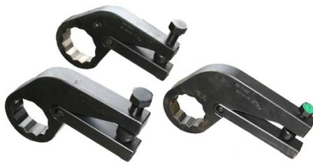
La contre clé de maintien manuelle à vis à été conçue pour stopper la rotation de l'écrou opposé à celui étant serré au moyen d'une clé dynamométrique hydraulique ou d'une visseuse. L'utilisation de la contre clé manuelle à vis est très simple. Lorsque le serrage est terminé et que la contre clé reste bloquée sur l'écrou opposé à celui étant serré , il suffit juste de débloquer la clé en dévissant la vis de réaction.
