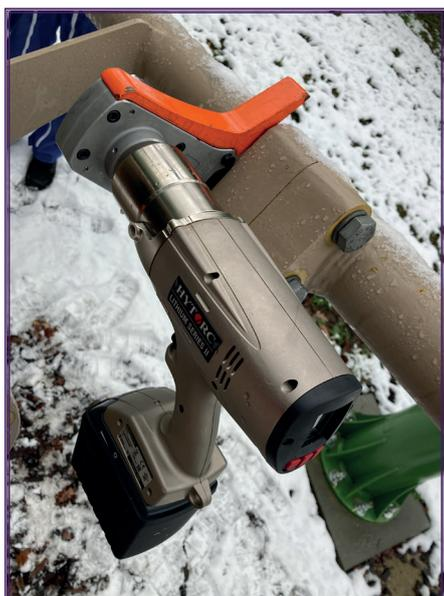
Les visseuses LST intègrent la technologie TorcSense™. (Vérification du couple par transducteur). Un transducteur de couple est intégré en sortie de moteur pour une meilleure mesure du couple final ainsi qu'une répétabilité accrue. L'utilisation d'un châssis en aluminium revêtu de nickel améliore très nettement la résistance à la corrosion.
